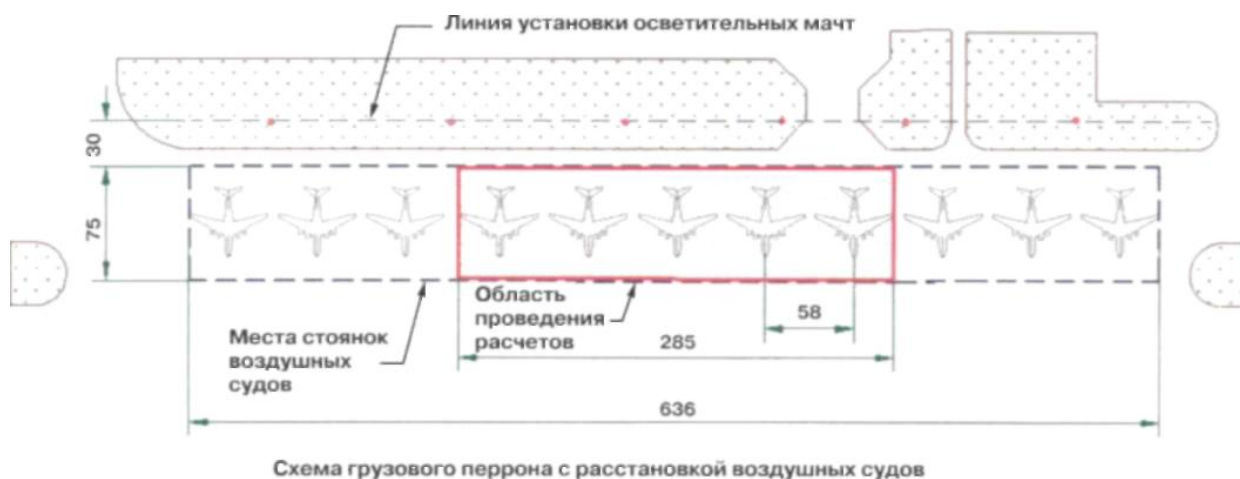
Рис.1. Светотехнический расчет осветительной установки для фрагмента грузового перрона в соответствии с международными и отечественными требованиями
